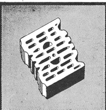
BEI VERWENDUNG VON B. K. S. TONKAMMERSTEINEN. Der Stein kann in jeder Lage leicht mit einer Hand gefasst und versetzt werden. Der Mauerungsvorgang ist denkbar einfach und geht rasch vor sich, da eine Steinbreite auch zugleich die ganze Mauerbreite darstellt. Die schmalen Kammern verhindern das Eindringen des Mörtels, werden von diesem nur überbrückt, sodass eine geschlossene Deckfläche entsteht.
