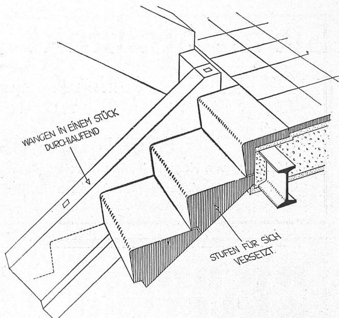
Detail der bei allen Typen verwendeten
