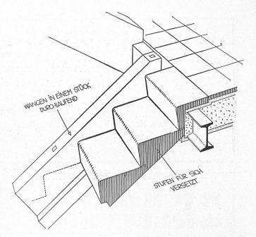
Detail der bei allen Typen verwendeten normalisierten Treppenkonstruktion
