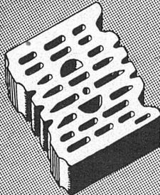
BEI VERWENDUNG VON B. K. S. TONKAMMERSTEINEN. Der Stein kann in jeder Lage leicht mit einer Hand gefasst und versetzt werden. Der Mauerungsvorgang ist denkbar einfach und geht rasch vor sich, da eine Steinbreite auch zugleich die ganze Mauerbreite darstellt. Die schmalen Kammern verhindern das Eindringen des Mörtels, werden von diesem nur überbrückt, sodass eine geschlossene Deckfläche entsteht.
