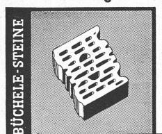
BEI VERWENDUNG VON B. K. S. TONKAMMERSTEINEN. Der Stein kann in jeder Lage leicht mit einer Hand gefasst und versetzt werden. Der Mauerungsvorgang ist denkbar einfach und geht rasch vor sich, da eine Steinbreite auch zugleich die ganze Mauerbreite darstellt. Die schmalen Kammern verhindern das Eindringen des Mörtels, werden von diesem nur überbrückt, sodass eine ge-schlossene Deckfläche entsteht.
