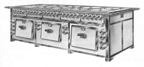
Elektrischer Grosskochherd mit 10 Kochplatten (8 runde und 2 rechteckige) und 3 Brat- und Backöfen Weiss emaillierte Ausführung mit vernickelten Beschlägen Wattaufnahme 41 kWh Elektrische Kippkesselbatterie jeder Kessel mittelst Handrad kippbar, Seiten- und Bodenheizung einzeln regulierbar
