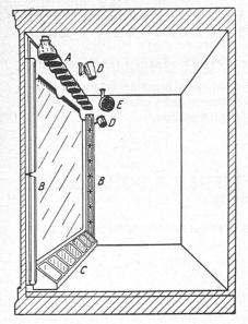
Abb. 2 Schaufensterbeleuchtung Vollständige Beleuchtungsanlage
