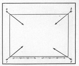
Abb. 3 Schaufensterbeleuchtung Anordnung der Lichtquellen bei farbiger Effektbeleuchtung
