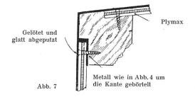
Durch Lötung und nachheriges sorgfältiges Abputzen kann eine Fügung erzielt werden, die nach dem Farbanstrich nicht mehr zu erkennen ist. Sind abgerundete Ecken erforderlich, können diese in derselben Art mit TEILANSICHT EINES RAUMES IN EINEM KAUFHAUSE IN MANCHESTER DIE EISERNEN SÄULEN SIND MIT PLYMAX UMMANTELT
