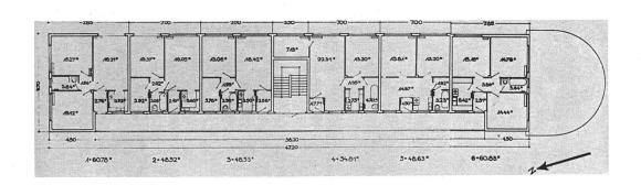
AUSSENGANGHAUS  $\times$  GRUNDRISS EINES WOHNGESCHOSSES  $\times$  Maßstab 1:400
