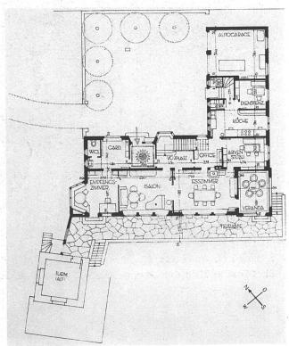
GRUNDRISS DES ERDGESCHOSSES Maßstab 1:400
