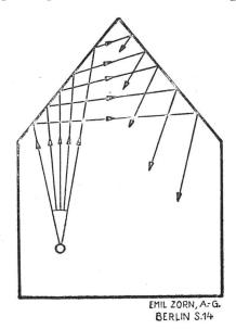
Von gotischen Decken doppelt zurückgeworfener Schall.
