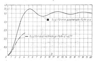
Abb. 2. Abhängigkeit der Strahlungsleistung rs ~ h (y) von y für eine quadratische und rechteckige Wand. Siehe Riegger, Zur Theorie des Lautsprechers, wissensch. Veröffentl. aus dem. Siem.-Konz. III. Bd. 1924, S. 68
