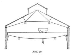
ist nur das direkte System am Platz, weil reflektierende Decken und Wände fehlen. Je nach den in solchen Räumen auszuführenden Arbeiten wird mit einer geringeren oder grösseren Gleichmässigkeit auszukommen sein-Man sieht daher entweder wenige, aber lichtstarke, oder mehrere, aber dafür kleinere Lampen vor. Abb. 9. Eine besondere Schwierigkeit in Montagehallen berei-
