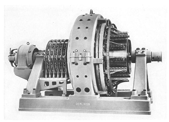
EINANKER-UMFORMER / ERSTELLT VON DER MASCHINENFABRIK OERLIKON
