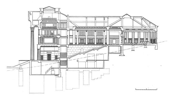
AUSGEFÜHRTER PLAN Schnitt durch die Mittelachse / Maßstab 1:500
