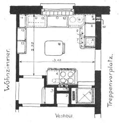
Abb. 9-11. Einrichtung der Küche der in Abb. 3 oben gezeigten Wohnung. Enthält zwei eingebaute Küchenschränke (6-9, 14-15).
