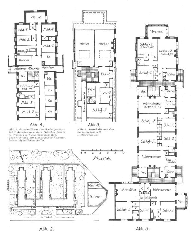
Abb. 2. Situationsplan des ganzen Blockes. Geschlossene Bauweise, aber keine geschlossenen Höfe. Minimum von Umgebungs- und Gartenarbeiten. Grossgarage.
