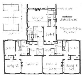
Abb. 1. Grundriss eines Wohnhauses in New York. 12 Etagen mit je 6 Wohnungen von zwei und drei Zimmern. Uebliche Stahlkonstruktion mit Backsteinfüllung. Links oben Plan des ganzen Baues. (Cl = \*Closet\*, d.h. betretbarer Wandschrank.)
