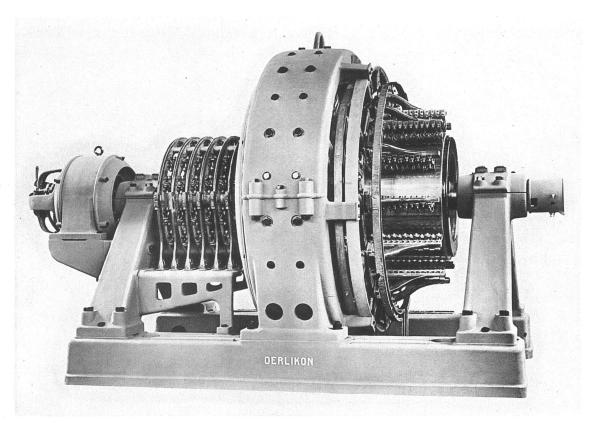
EINANKER-UMFORMER / ERSTELLT VON DER MASCHINENFABRIK OERLIKON
