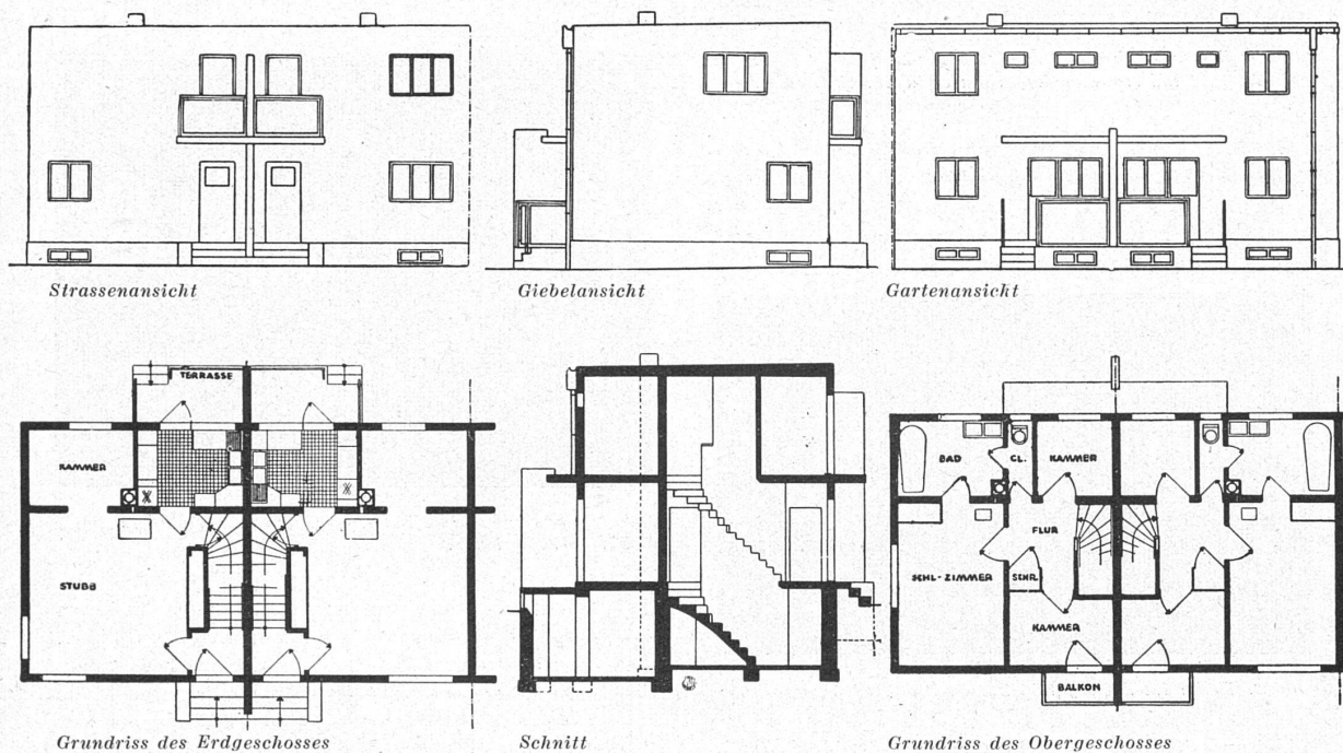
Abb. 7. Zweifamilien-Haustyp der Montagebauten in Frankfurt-Praunheim / M. 1:200
