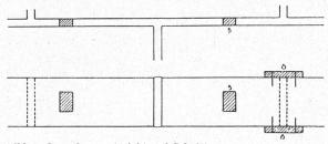
Abb. 6. Lagerfuge / Ansicht und Schnitt 5 = Betonklötze 6 = Bretter zum Vergiessen der Stossfugen
