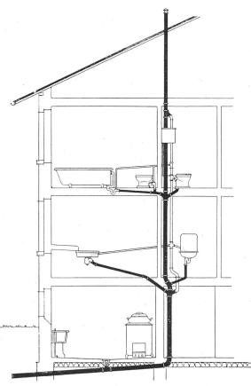
Abb. 1. In Eternit-Röhren ausgeführtes Rohrnetz.
