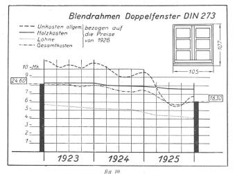
Graphique démontrant la réduction progressive des prix de châssis de fenêtres normalisés par suite de leur fabrication rationnelle en série
