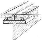
Abb. 2. Bleibandprofil für Neigungen unter 35°.
