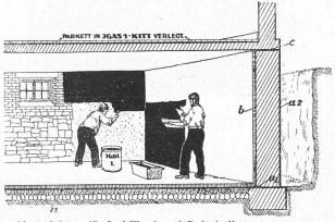
Abb. 15. Schema für Igol-Wand- und Bodenisolierung.
