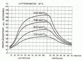
Abb. 4. Oberflächentemperaturen der »Maxim«-Fussbankheizkörper mit 83 mm äusserm Rohrdurchmesser, bei verschiedenen Belastungen, während des Aufheizens und Abkaltens.
