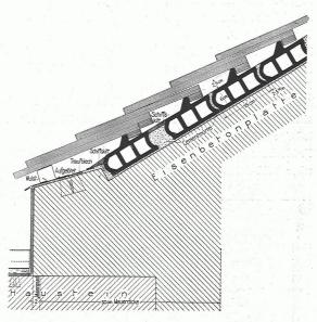
Abb. 8. Dachkonstruktion unter Verwendung von Dach-Hourdis, System Knobel.
