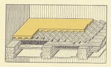
Abb. 2. Euböolithfussboden mit Lättlirost auf altem Bretterboden.
