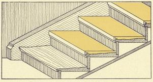
Abb. 4. Euböolithüberzug auf Holztreppe unter Verwendung eiserner Vorstoßschienen.
