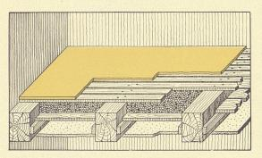
Abb. 3. Euböolithfussboden mit Dachlattenrost auf Holzgebälk.
