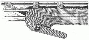
Abb. 8. Befestigung von Schilfrohrgewebe unter einer Holzdecke.
