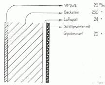
Abb. 9. Backsteinmauer, aussen verputzt, innen mit Schilfgewebebelag und Gipsbewurf.
