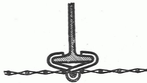
Abb. 6. Befestigung von Rauchs Reformrabitzen an eisernen T-Balken.
