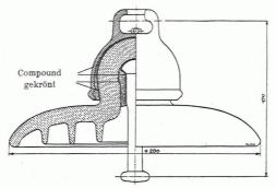
Abb. 1. Schnitt durch einen Hängeisolator »Langenthal«.
