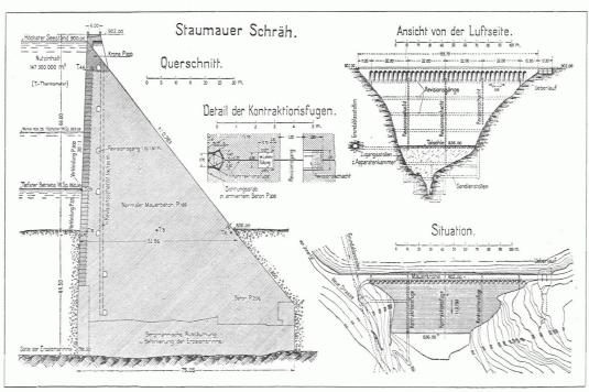
51. STAUMAUER SCHRÄH / QUERSCHNITT
