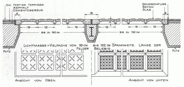
Abb. 5. Luxfer-Glasbeton-Detail.
