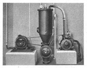
Abb. 6. Staubsauganlage System C. Ziegler, Schaffhausen mit Spülfilter.
