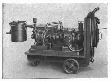
Abb. 15. Fahrbare »Elmo«-Entstäubungspumpe der Siemens-Schuckertwerke.
