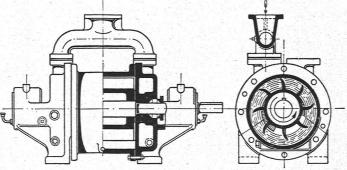
Abb. 13. Die »Elmo«-Luftpumpe der Siemens-Schuckertwerke im Schnitt.
