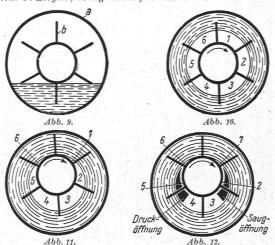
Abb. 9-12. Erläuterung der Wirkungsweise der »Elmo«-Luftpumpen.
