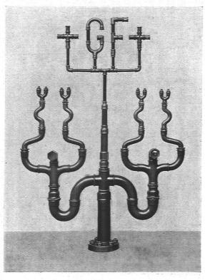
Abb. 1. Zusammenstellung von Weichguss-Fittings, Marke + GF+ die in der Materialprüfungsanstalt der Eidgenössischen Technischen Hochschule auf einen innern hydraulischen Druck von 250 Atm. geprüft wurde.
