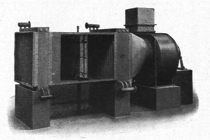
Heizkammer mit Luftwascheinrichtung. Tropfenfänger und Zentrifugal-Ventilator zur Erwärmung von 11000 m³ Luft pro Stunde von -5° auf + 22° C.
