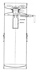
Abb. 8. Schnitt durch den Zuber'schen Feuerlöschapparat (Abb. 7).
