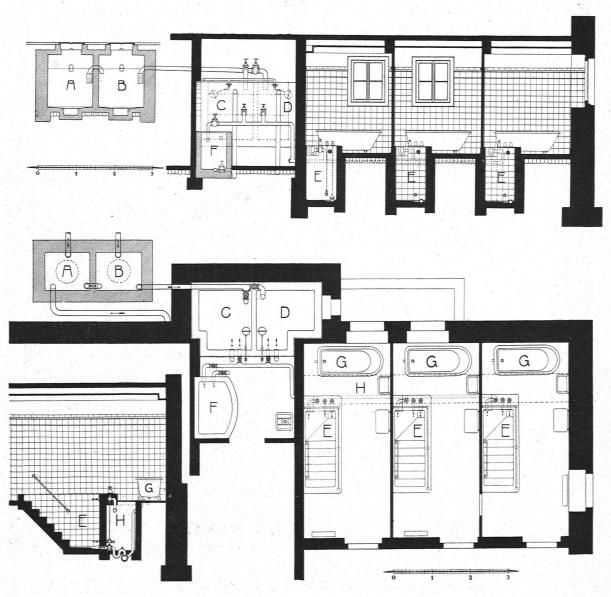
Abb. 2. Längs- und Querschnitt, sowie Grundriss der Tauchbadanlage in der Synagoge an der Freigutstrasse, Zürich 2.
