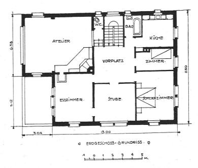
ABB. 14 HAUS THOMANN GRUNDRISS IM ERDGESCHOSS
