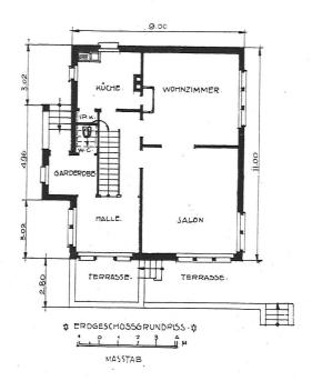
ABB. 18 HAUS NABHOLZ, ZOLLIKON GRUNDRISS IM ERDGESCHOSS
