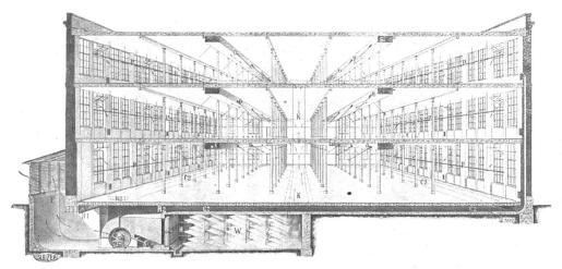
F — Frischluftkanal C $_2$  — Umluftkanäle R — Regulierklappen K — Verteilkanäle O — Luftaustrittsöffnungen H — Lufterhitzelemente W — Luftbefeuchtungseinrichtung
