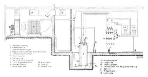
Schema der elektrischen Warmwasser-Luftheizung. Spannung 3000 Volt (später 6000 Volt).
