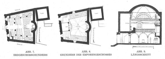
Erdgeschossgrundriss: Die Stellung und Anlage des quadratischen Altars im Zentrum des durch Emporen und Kanzelwand gebildeten Quadrates, senkrecht unter der Mittelrosette des Stuckgewölbes, ist eine Annahme des Verfassers und gründet sich auf die Vermutung, dass der jetzige in seinen Teilen uneinheitliche Altartisch aus Holz schräg unter der niedern Kanzel vom Architekten kaum so projektiert worden war.
