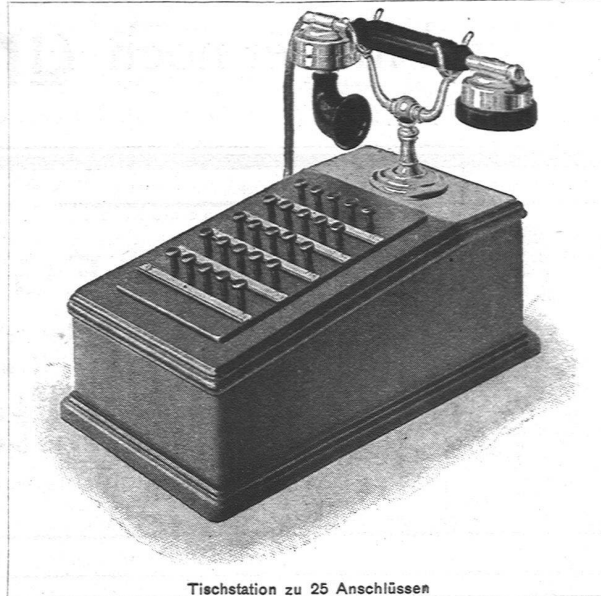
Tischstation zu 25 Anschlüssen
