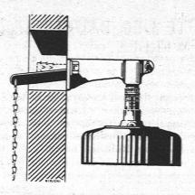
Lufttemperatur-Regler, durch Hebelübertragung wirkend
