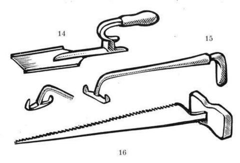
Fig. 14 boutoir du maréchal. Fig. 15 boutoir du sabotier. Fig. 16 scie-botte du charpentier.
