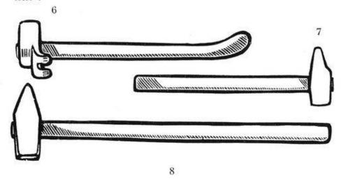
Fig. 6–8 marteaux du maréchal: Fig. 6 marteau à ferrer les chevaux. Fig. 7 marteau à main. Fig. 8 masse ou batterand.
