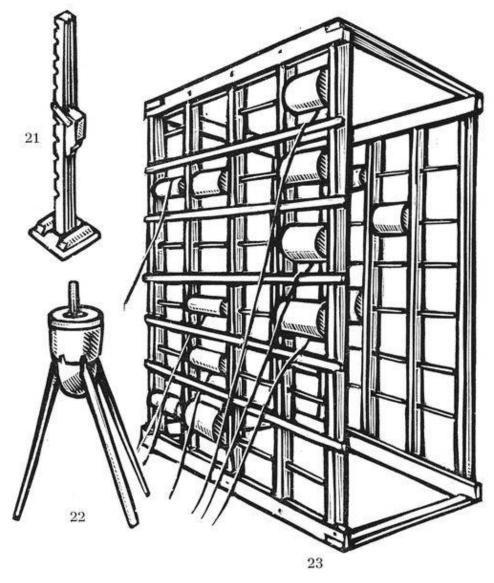
Fig. 21 servante du menuisier. Fig. 22 servante du charron. Fig. 23 servante du cordier.
