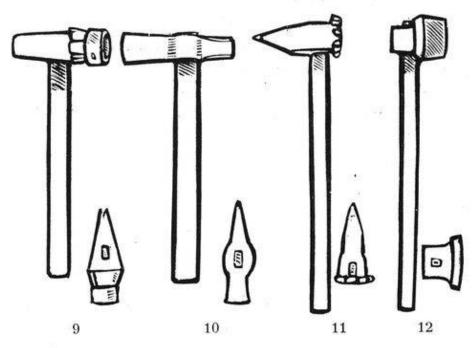
Fig. 9 「chasse du tonnelier. Fig. 10 「tranche du maréchal. Fig. 11 「étampe du maréchal. Fig. 12 「chasse du maréchal.
