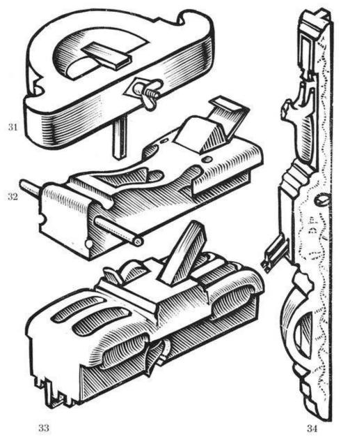
Fig. 31  $\lceil oisillon \rceil$  du charpentier. Fig. 32  $\lceil gal\`ere \rceil$  du charpentier. Fig. 33 bouvet du charpentier. Fig. 34  $\lceil joigneur \rceil$  du charpentier.
