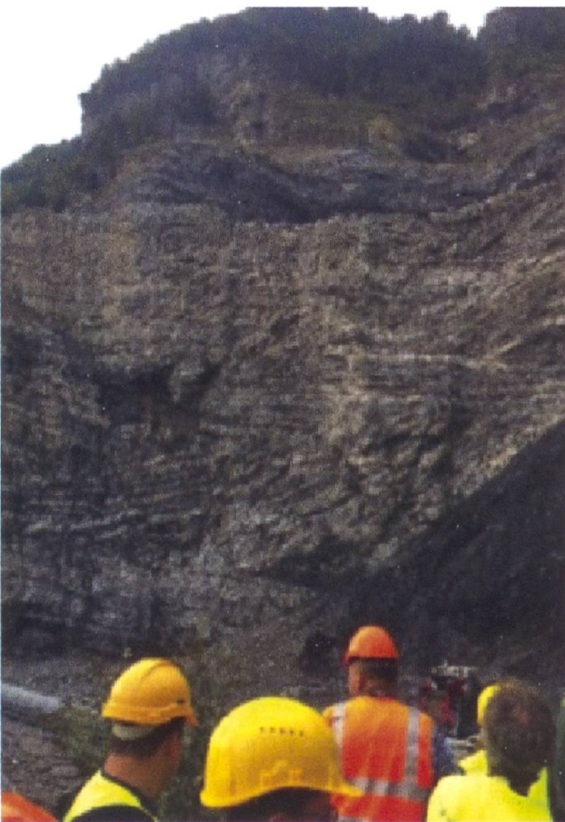
Fig. 2: Blick auf die Abbaustelle mit den mächtigen und dem stark verfalteten Altdorfer Sandstein.
