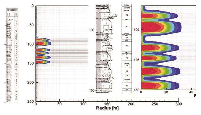
Fig. 2: Modellaufbau des Geospeichers mit sechs Sandsteinlagen. Die farbigen Kontourflächen zeigen exemplarisch die Temperaturverteilung für einen gegebenen Zeitpunkt [1].
