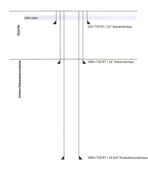
Fig. 5: Darstellung der Absetzteufen der Futterrohre [1]
