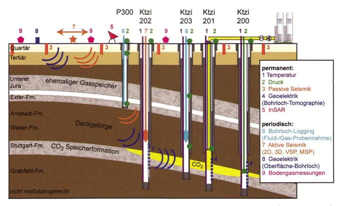
Fig. 4: Monitoringkonzept für den geologischen CO<sub>2</sub>-Speicher in Ketzin, modifiziert nach (Wipki et al. 2016).
