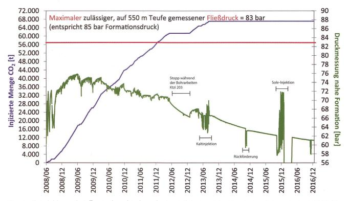
Fig. 3: Entwicklung des Formationsdrucks mit der injizierten  $CO_2$ -Menge im Zeitraum Juni 2008 bis Dezember 2016.
