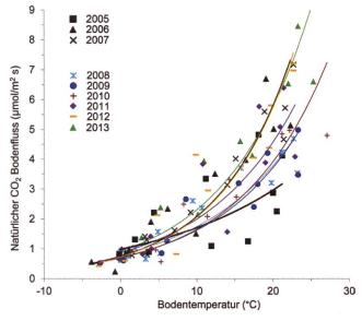
Fig. 5: Station zur Messung des CO<sub>2</sub>-Bodenflusses und der Bodentemperatur auf dem Betriebsgelände in Ketzin (links, Zimmer et al. 2011). Daten aus der Phase der CO<sub>2</sub>-Injektion 2008-2013 zeigen den gleichen typischen Jahresverlauf wie Daten aus der Pre-Injektionszeit 2005-2007 (rechts).
