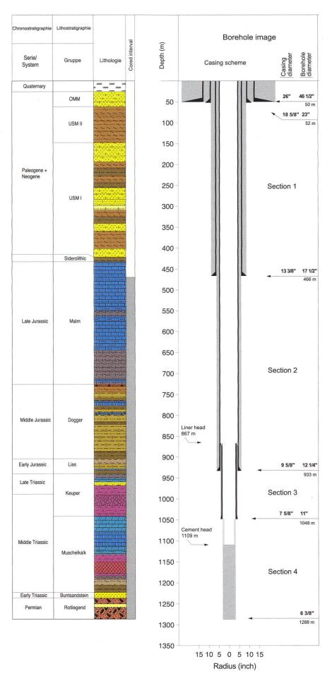
Fig. 6: Bohrlochbild der Tiefbohrung Stadel-2 im Standortgebiet Nördlich Lägern (aus Nagra 2022b); entspricht nicht dem Endausbauzustand.
