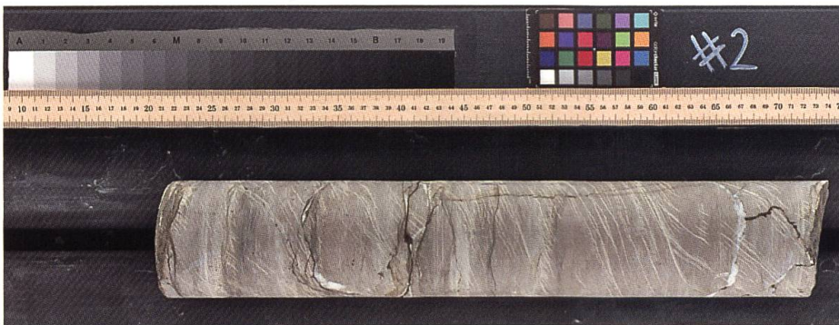
Fig. 5: Hochauflösender optischer Scan eines Bohrkerns der Tiefbohrkampagne. Foto: Nagra.
