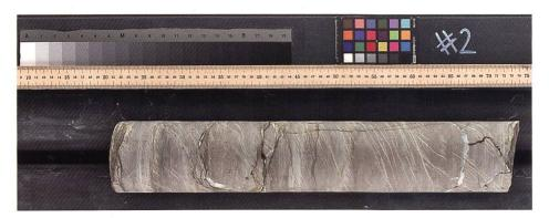
Fig. 5: Hochauflösender optischer Scan eines Bohrkerns der Tiefbohrkampaqne. Foto: Nagra.
