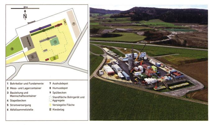
Fig. 2: Links: Skizze der geplanten Bohrplatzauslegung der Tiefbohrung Stadel-3; rechts: Vollständig eingerichteter Bohrplatz. Die Tiefbohrung Stadel-3 befindet sich im Standortgebiet Nördlich Lägern und wurde mit einem Langzeitbeobachtungssystem ausgestattet. Foto: Nagra.
