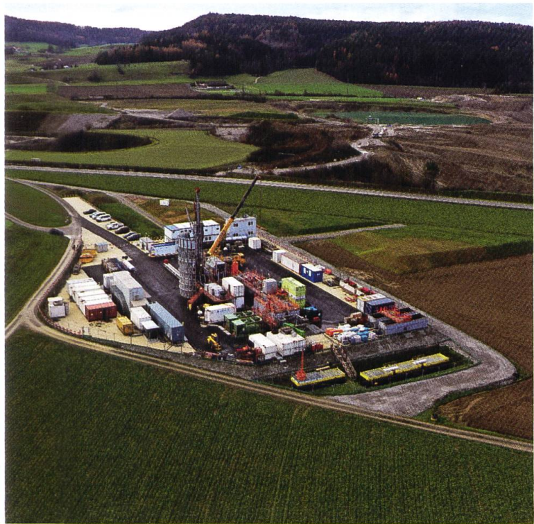
Fig. 2: Links: Skizze der geplanten Bohrplatzauslegung der Tiefbohrung Stadel-3; rechts: Vollständig eingerichteter Bohrplatz. Die Tiefbohrung Stadel-3 befindet sich im Standortgebiet Nördlich Läger und wurde mit einem Langzeitbeobachtungssystem ausgestattet. Foto: Nagra.
