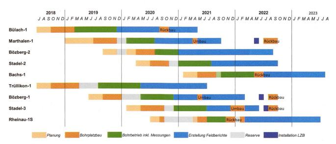
Fig. 3: Übersicht über den generellen Ablauf der Tiefbohrkampagne mit Zeitstrahl (x-Achse) und Bohrplatzbezeichnung (y-Achse). Stand: Dezember 2022.
