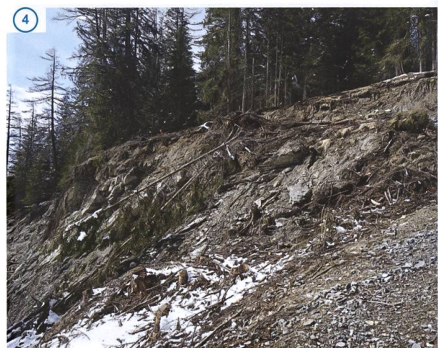
Fig. 3: Struktur- und geomorphologische Detailkarte, Caltgeras (oben links, Ausschnitt vgl. Fig. 1); Fotos 1 und 2: aktive Kippflächen innerhalb der Schiefer der Allgäu-Formation (Fm); Foto 3: steil bergwärts einfallende Zugspalten in den Rauwacken der Raibler-Formation. Foto 4: aktiver Anriss im Bereich des Flyschs (Westrand).
