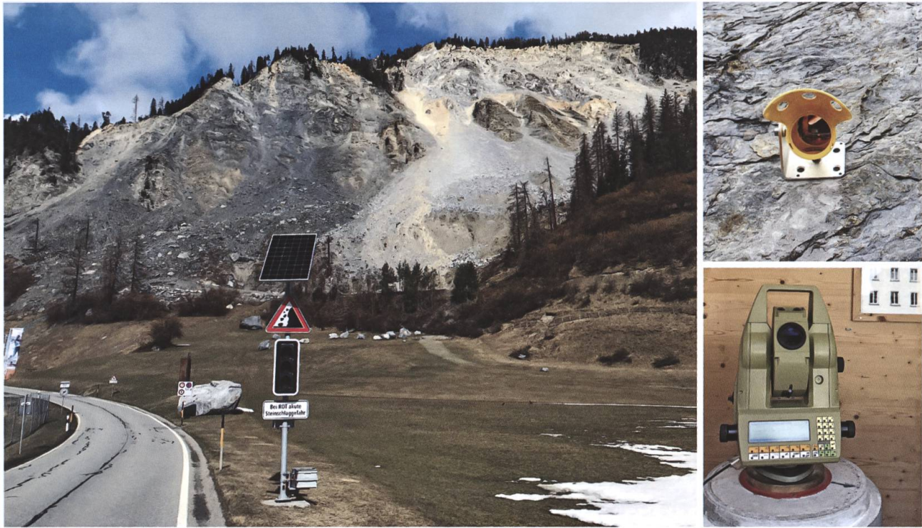
Fig. 4: Ampelanlage, die durch das Doppler-Radar gesteuert wird (links), Reflektor (oben rechts), Tachymeter (unten rechts).
