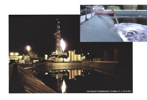
Fig. 1: Mit dem Produktionstest in St. Gallen wurden Erdgas und Wasser gefördert. Insgesamt konnten in einer zweiten Testphase ca. 3500 m³ Wasser und 400'000 m³ Erdgas gefördert werden. Betrachtet man die potenzielle thermische Bruttoleistung der geförderten Medien so entspricht das ca. 1–2 MW für das Wasser und 60 MW für das Erdgas.
