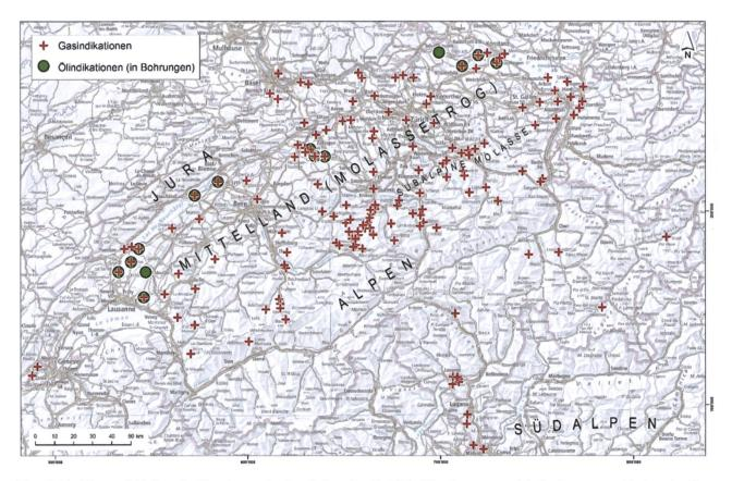
Fig. 2: Erdöl- und Erdgasindikationen in der Schweiz. Erdölindikationen aus Tiefbohrungen, Erdgasindikationen aus verschiedenen Bohrungen und an der Oberfläche.
