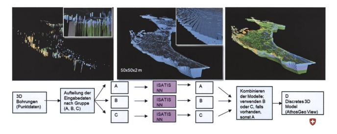
Fig. 10: Das eigentliche Modellierungsverfahren. Es werden drei Modellierungsgruppen mit jeweils eigenen Parametern definiert, um die sehr unterschiedlichen Ablegerungsprozess zu widerspiegeln.
