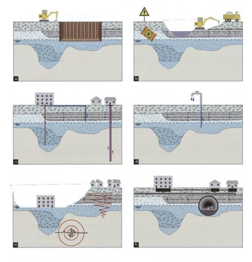
Fig 1: Verschiedene Nutzungen im Lockergestein, wobei die Eigenschaften der quartären Lockergesteine eine entscheidende Rolle spielen. a) Baugrund und Geotechnik, b) Materialbeswirtschaftung, c) untiefer Geothermie, d) Grundwassergewinnung, d.h. Trinkund Brauchwasser, e) Naturgefahrenprävention, f) «Building Information Modeling (BIM)» (Figur swisstopo).
