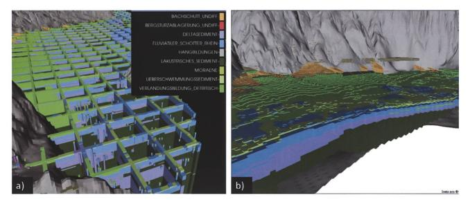
Fig. 11: Geologisches 3D-Modell. a) Visualisierung durch eine Reihe von N-S und E-W orientierten Schnitten durch das Modell in Kombination mit den Eingabebohrungen. b) ein Schnitt entlang des Rheins mit Blick nach Westen. Hier führt das Fehlen von Daten in der Tiefe dazu, dass das Modell in Richtung des oberen Teils des Grundgebirges leer ist.
