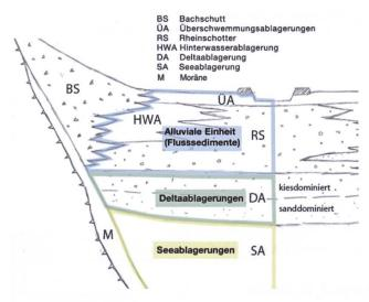
Fig. 6: Schemaschnitt Talfüllung mit den übergeordneten lithöstratigraphischen Einheiten.
