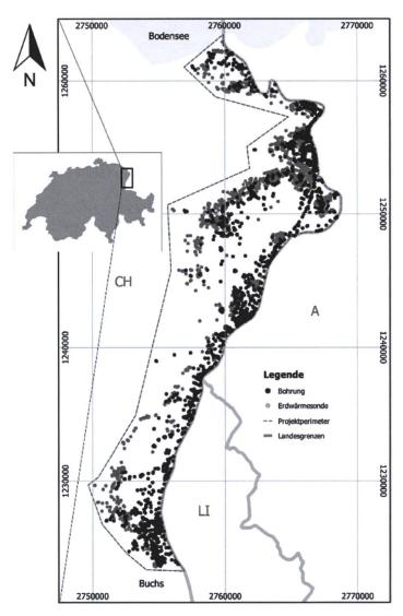
Fig. 3: Projektperimeter und Datensatz; Bohrungen (3479 Stück, 100.0%) und Erdwärmesonden (1685 Stück, 48.4%) im Projektperimeter mit den Landesgrenzen Schweiz (CH), Fürsten-tum Liechtenstein (FL) und Österreich (A).
