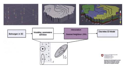
Fig. 8: Vereinfachtes Bild, das die Erstellung eines 3D-Modells zeigt; aus harmonisierten Boh-rungen in 3D, der Erstellung eines leeren Voxelmodells, der Interpolation «nearest neighbour» mit einem Suchellipsoid und dem daraus resultierenden diskreten geologischen Modell.
